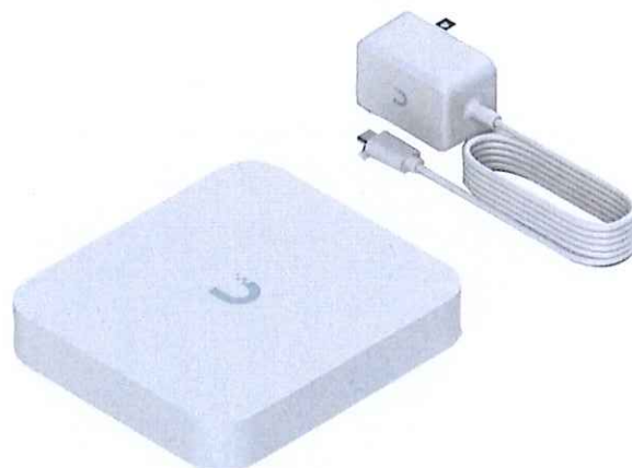
Figura 18 Componentes de la controladora UniFi
