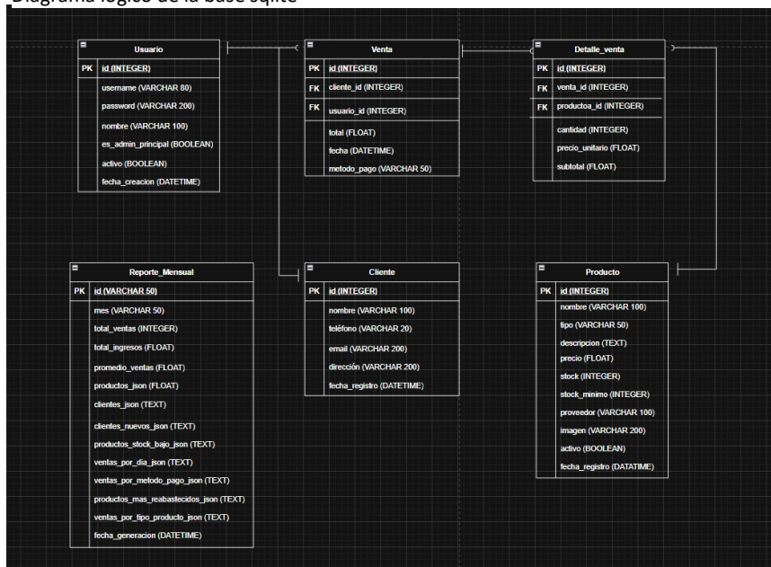
Ilustración 4 Diagrama lógico de la base sqlite
