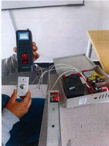
Descripción: Prueba de conexión del biométrico con la caja de fuente de alimentación.
