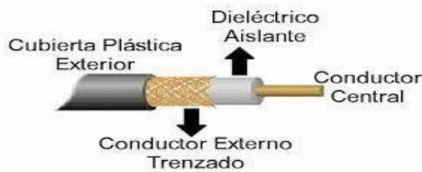
Nota: La **ilustración 10** da a conocer el cable coaxial y sus partes con su distinguido nombre.
