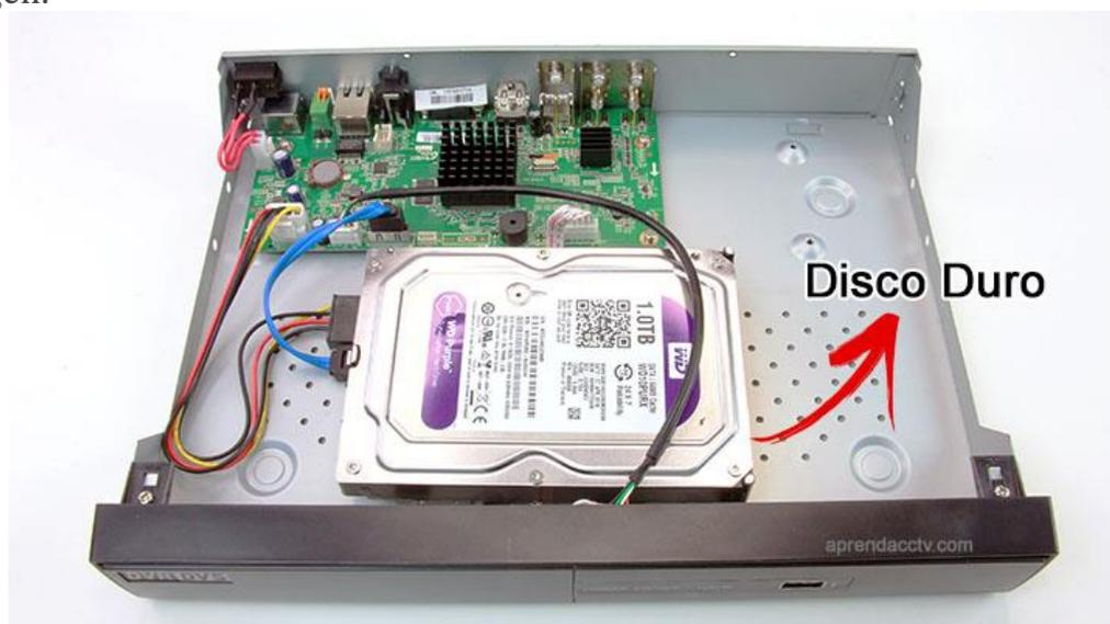
Solo necesita abrir la grabadora para instalar físicamente el disco duro y conectar los cables de alimentación y de datos. Es un proceso fácil que no requiere habilidades técnicas.
