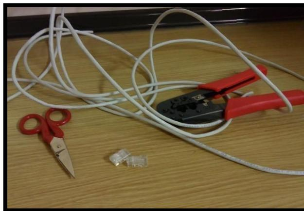
*Figura N° 1: Crimpado de cable de red para el DVR
