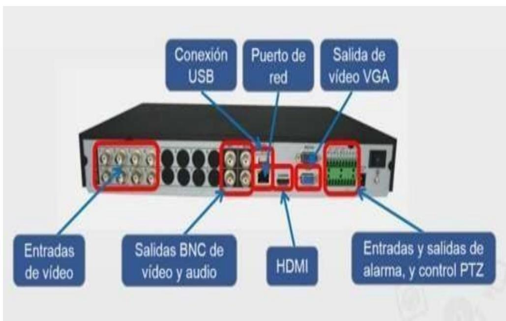
*Ilustración 12: Partes de DVR Grabador (Sosio, S.O.S SEGURIDAD, 2017).*
